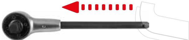
2. Установить мультипликатор вместе с торцевой головкой на гайку или головку болта. В зависимости от необходимой технологической операции, использовать вороток или динамометрический ключ. Ручка мультипликатора используется в качестве упора. Устанавливается против предполагаемого направления вращения.
